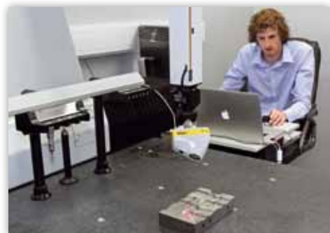
Eine Hälfte einer Druckgussform, die auf dem LK V 8.7.6 KMG (Messbereich 800 x 700 x 600 mm) gescannt wird.
