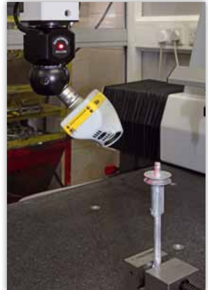
Nikon LC15Dx beim Scannen einer Antriebswelle aus Zinkdruckguss
