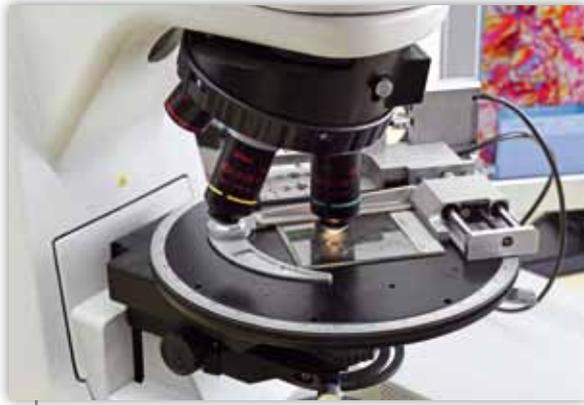
*Herzstück eines PETROG-Systems ist der hier abgebildete kompakte, rotierende, schaltende Objektisch, der am Nikon Mikroskop angebracht ist.*
