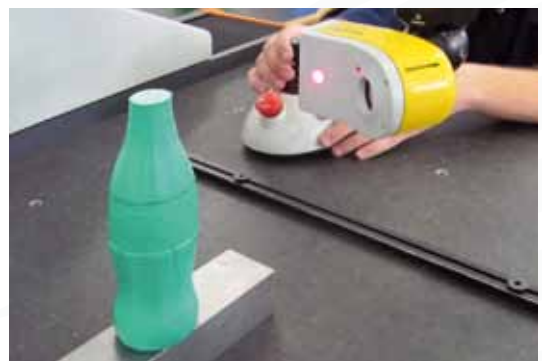
Die Programmierung des Scanpfads erfolgt im Teach-und-Learn-Verfahren.
