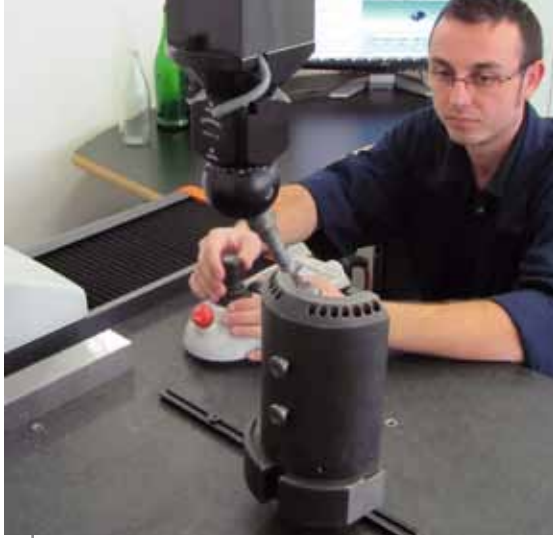
Durch den Einsatz eines multisensorfähigen CNC-KMGs wird der Messdurchsatz bei der Endabnahme einer Glasflaschenform verdreifacht.
