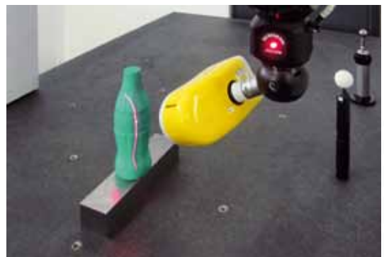
Der LC50Cx digitalisiert praktisch alle Oberflächen, einschließlich glänzender Werkstoffe.
