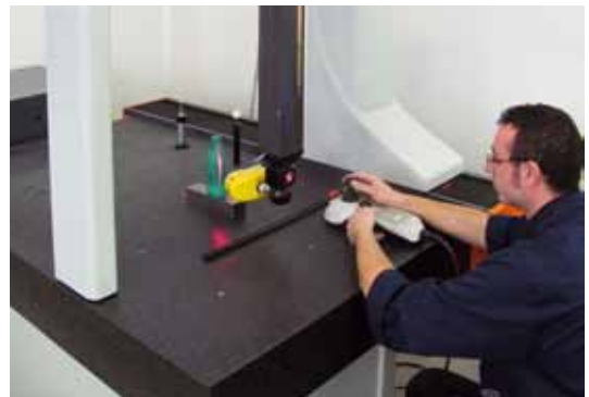
Der am KMG installierte digitale LC50Cx Streifenlaserscanner prüft das Harzmodell einer Coca-Cola-Flasche.
