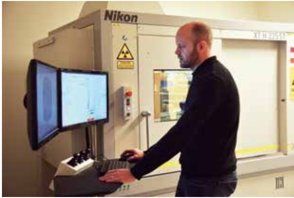
■ Carl-Anton Manns am Nikon Metrology XT H 225 ST Prüfsystem, das zur Validierung von Zuliefererteilen und neuen Bauteilen bei Nordic Lights eingesetzt wird
