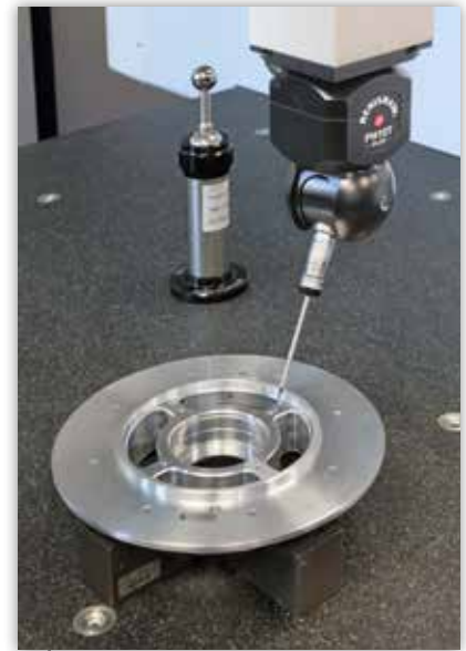
Das Turbinenteil aus Aluminium wird Nisan Engineering, Leicester, in einer Zykluszeit von 10 Minuten gemessen.
