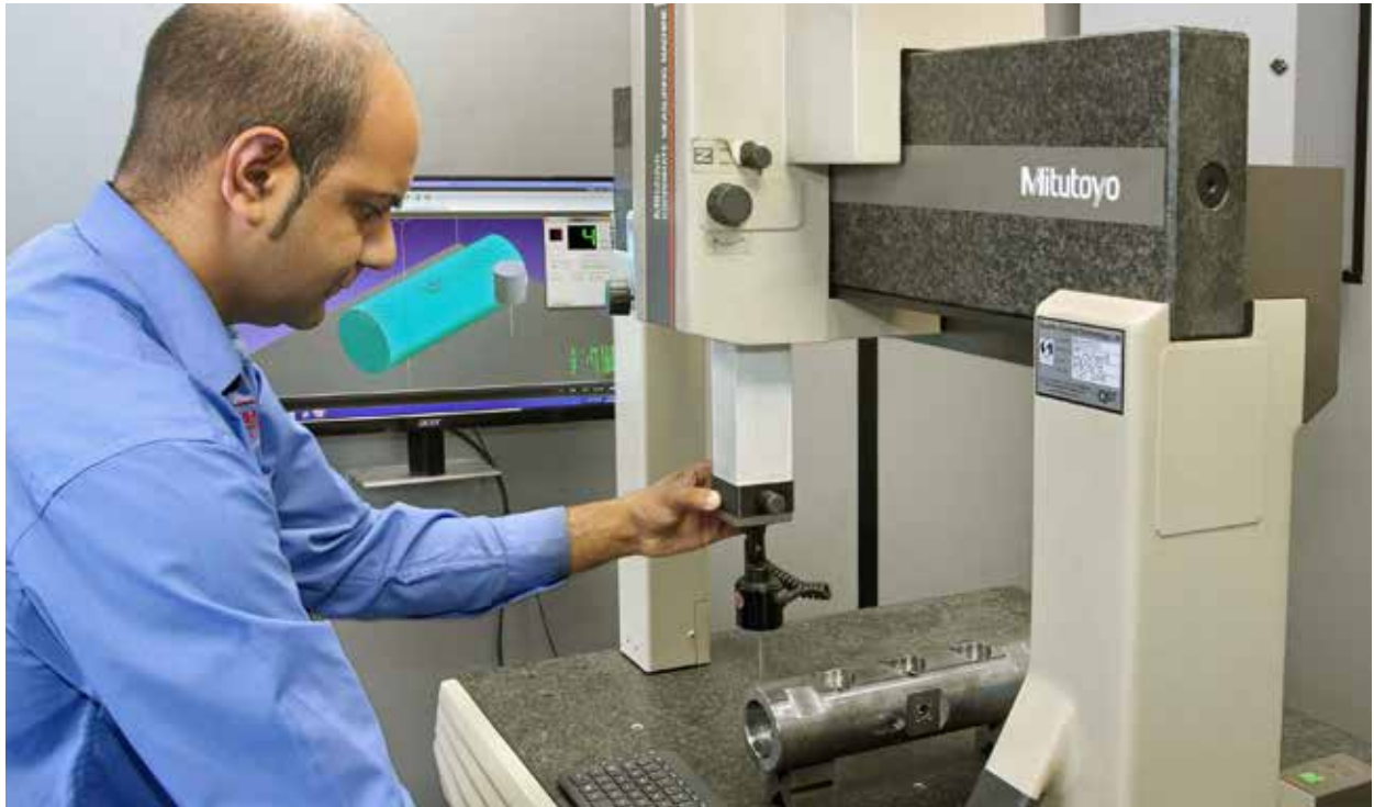
Derselbe Zylinder wird auf dem manuellen Mitutoyo KMG, das mit der Software CMM-Manager nachgerüstet wurde, gemessen.
