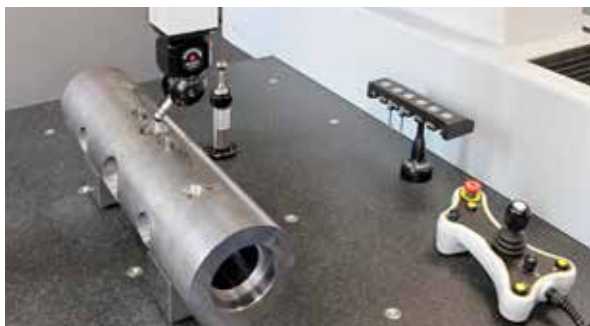
Einer der Gasdurchfluss-Messzylinder aus Vergütungsstahl mit 130 mm Durchmesser und 550 mm Länge, der in einem 9-minütigen Messzyklus geprüft wird.
