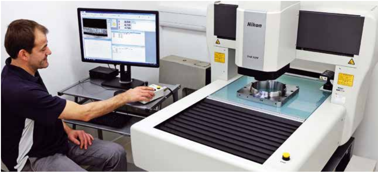
Graham Cranfield, gedelegeerd bestuurder van Microtec, inspecteert een groter onderdeel op de iNEXIV, in dit geval een stalen ring voor een matrijsholte.
