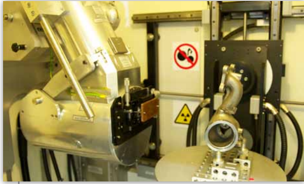
Die XT H 450 Mikrofokusröntgenröhre eignet sich für das Scannen kleiner Gussformen, um Einblick in die Innenstruktur des Teils zu gewinnen.
