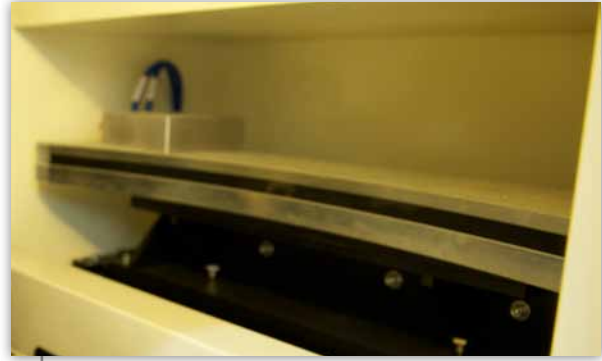
Der Curved Linear Array-Diodendetektor (CLDA) sorgt für eine optimale Erfassung der Röntgenstrahlen und verhindert, dass die Streustrahlung aufgenommen wird, die in der Regel die Verzerrung der 2D-Röntgenbilder von Turbinenschaufeln und sonstigen Metallteilen verursacht.
