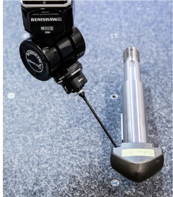
■ Mit dem Messtaster Revo kann man bei sehr hohen Geschwindigkeiten problemlos dreidimensional taktil scannen.
