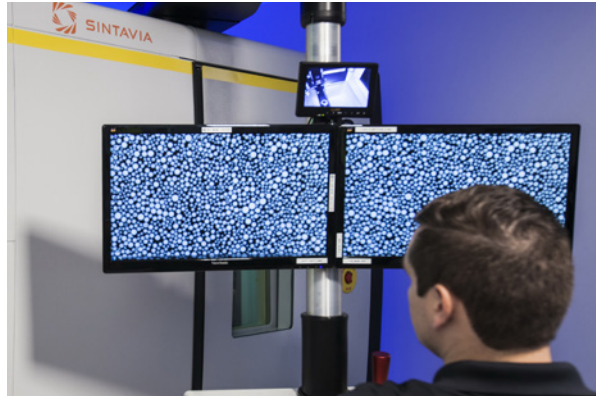
■ Le système à TN micro-focus permet de visualiser chaque particule de poudre métallique.
