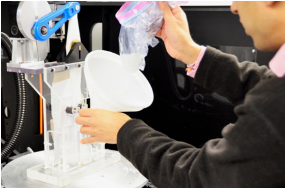
■ Bestückung des CT-Systems mit einem Mechanismus, der Kunststoffkugeln für ein 4D CT-Experiment zur Simulation des Paronuss-Effekts (BNP) enthält.
