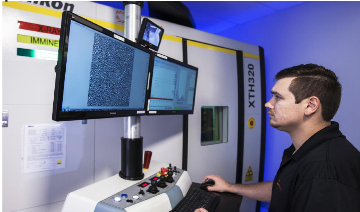
Polvo de metal para la Manufactura Aditiva que está siendo inspeccionado con el escáner micro TC de Nikon Metrology en Sintavia
