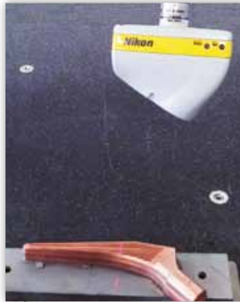
Der LC15Dx scannt das komplette Teil mit wenigen einfachen Bewegungen.
