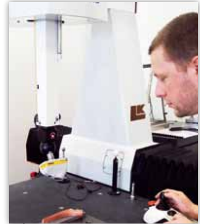
Programmierung eines Scanzklus' für die Flächenrückführung (RE) einer Kupferelektrode, die für die Herstellung eines Hüftschaff-Implantats verwendet wurde.
